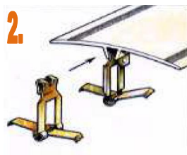
Changer le sens d'introduction un clip sur deux
