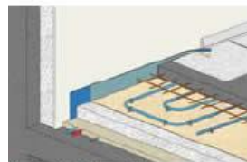
Plancher chauffant eau chaude
